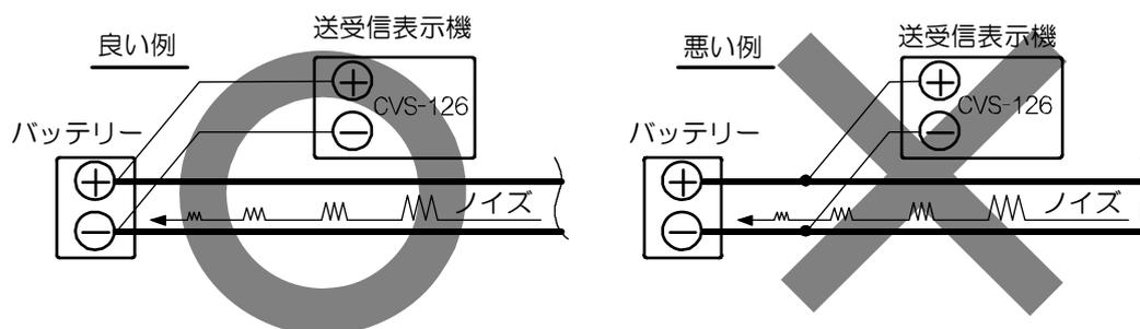
図 5.1 電源ラインの接続方法
